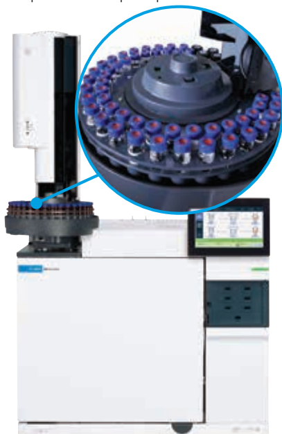
Автосамплер 7650A емкость 50 флаконов
