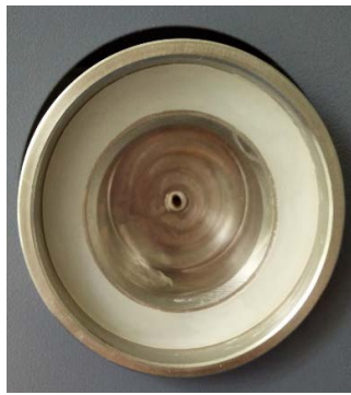
Вторичное окно с установленной защитной пленкой, подготовленное для установки кюветы
