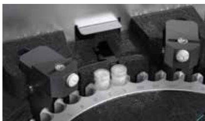
Карусель автосамплера с датчиком флаконов и входными/выходными подъемниками
